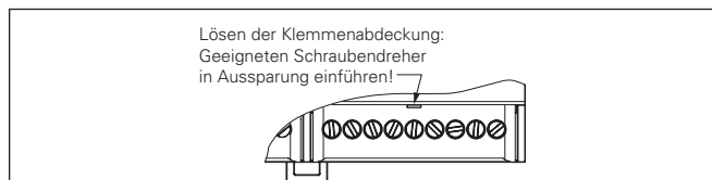
Abb. 2 Lösen der Klemmenabdeckungen (REG-Variante)
